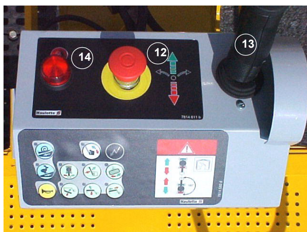
Foto 5 : Posto di comando piattaforma
